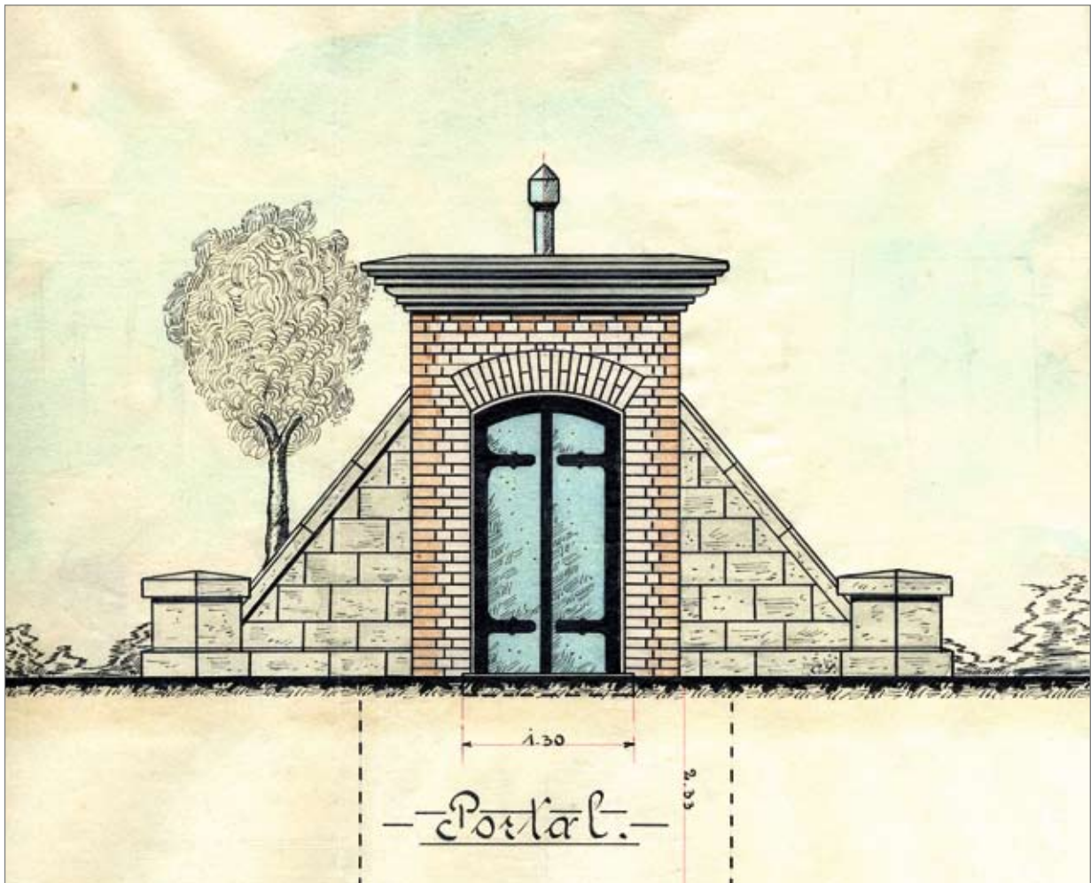
Wassergewinnungsanlage Müschede, Stolleneingang mit aufwändig gestalteten Portal- und Pfeilerabdeckungen in profiliertem Sandstein. In der Mittelachse über der zweiflügeligen Eingangstür das Ventilationsrohr zur Stollenbelüftung. Der Portalbau ist in diesem ursprünglichen Erscheinungsbild nicht erhalten.
